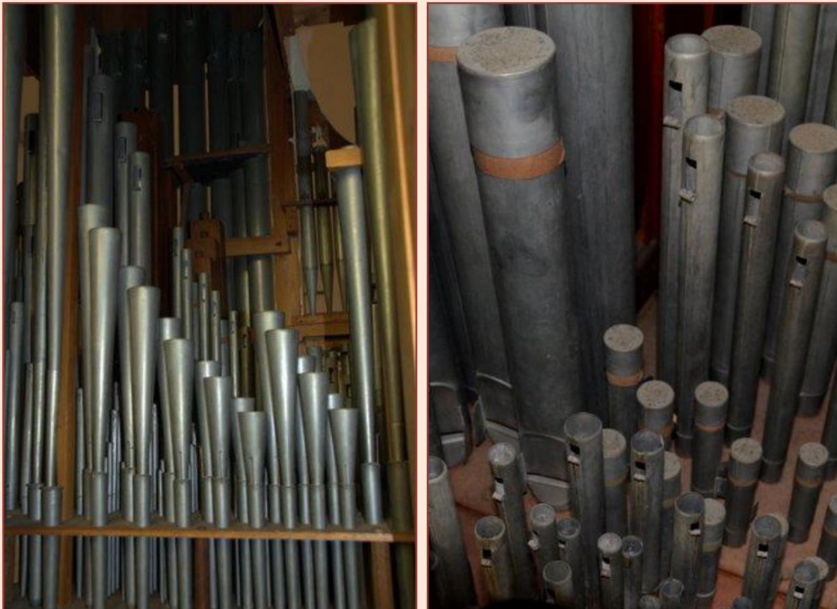
Het pijpwerk is grotendeels gemaakt van een tin/lood legering waarbij het percentage tin hoog is. De technische toestand was gezien de leeftijd uitzonderlijk goed, er zijn in 2024 wel kleine reparaties uitgevoerd zodat het pijpwerk technisch weer in optimale staat is.
