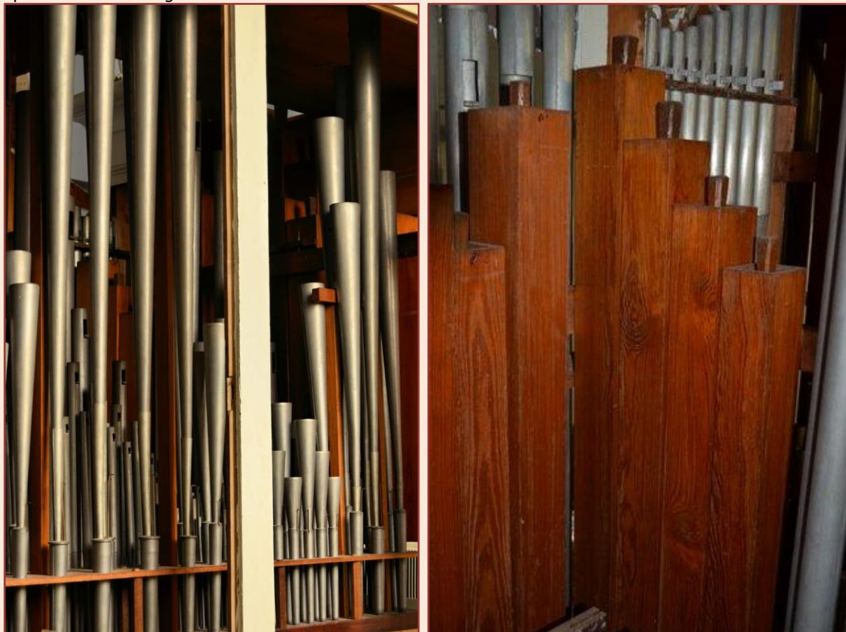
Ook op de constructie van de Trompet 8' is niet bezuinigd. Bakker & Timmenga heeft hier vanaf c° een constructie met dubbele koppen toegepast (een ring & noot constructie) zodat de beker en ook de klank stabieler staat en het tongwerk vaster op stemming blijft.
