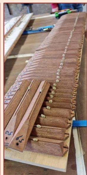
Die meisten Pfeifen der Orgel befinden sich auf der Windlade. Diese ist in gewohnt klassischer Weise gefertigt. Bei der Restaurierung 1971 wurden die Dämme zwischen die Registerschleifen erhöht um Platz für den Teleskophülsenverschluss (mit Druckfedern) zu schaffen. Die Pfeifenstücke (aus Mahagoni) wurden angepasst. 2023 wurde die Windlade komplett restauriert. Die Schleifendichtung von 1971 wurde nach Überholung behalten. Die Lederpulpete wurden durch neue ersetzt.
