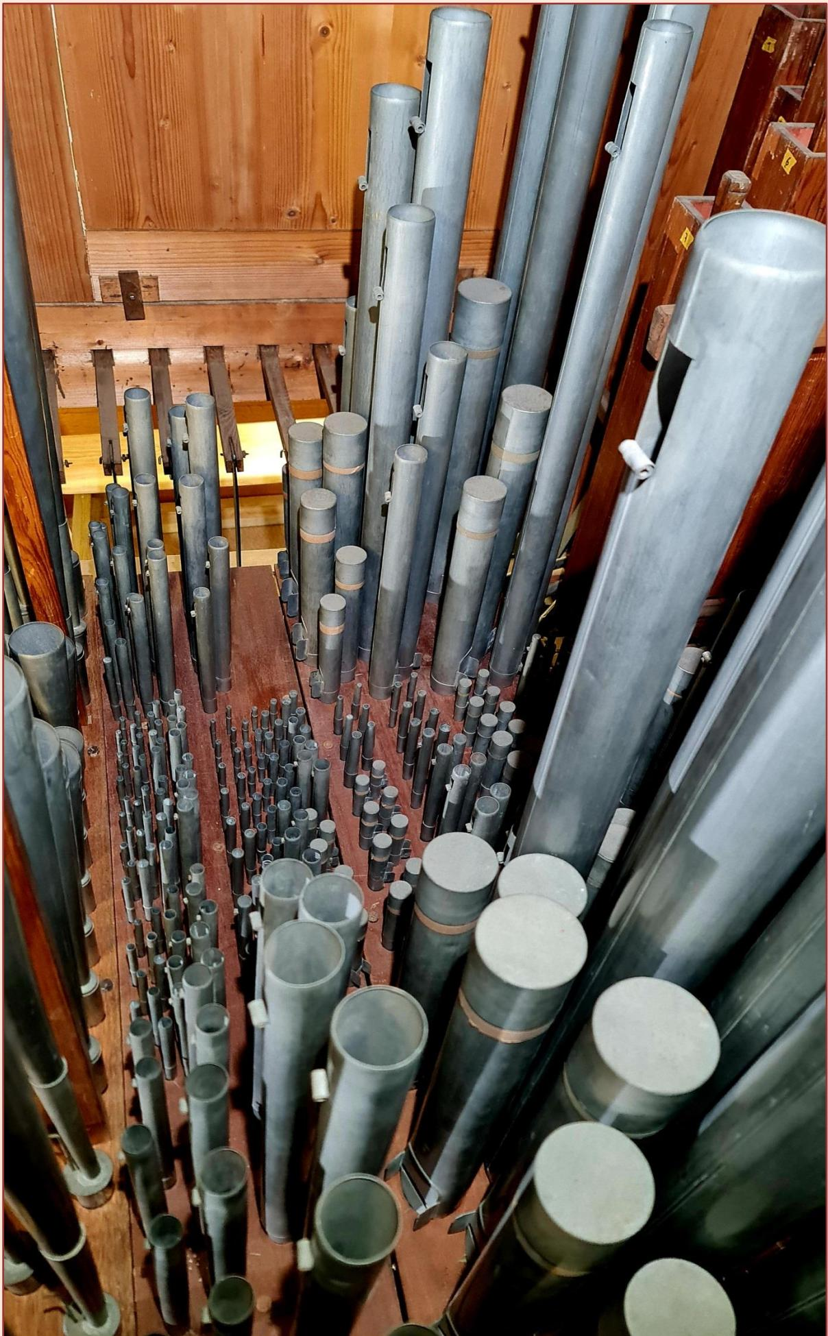
Die Orgelpfeifen bestehen größtenteils aus einer Zinn/Blei-Legierung mit einem hohen Zinnanteil. Der technische Zustand war außergewöhnlich gut. Im Jahr 2024 wurden nur kleinere Reparaturen durchgeführt, so dass sich die Pfeifen wieder technisch in einem optimalen Zustand befinden.
