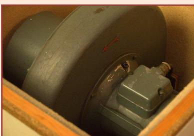
De ventilator (van het Zwitserse fabrikaat Meidinger 220Volt) staat achter (buiten) de orgelkast in een geïsoleerde dempkist. De uitmonding is aangesloten op een windkanaal. De gewichten van gietijzer zijn origineel ondanks de verschillende uitvoeringen (er zijn gietijzeren platen, oude gietijzeren ramen en enige losse stukken gietijzer die bij elkaar de juiste winddruk bepalen).
