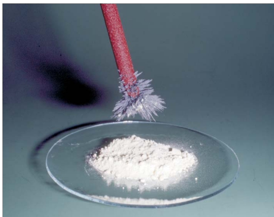
8.2 Magnet trennt Feststoffe
