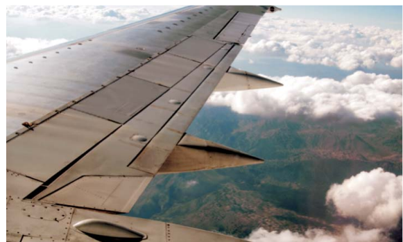
6.4 Duraluminium ist eine Legierung von Aluminium mit Kupfer, Magnesium, Mangan und Silicium.
