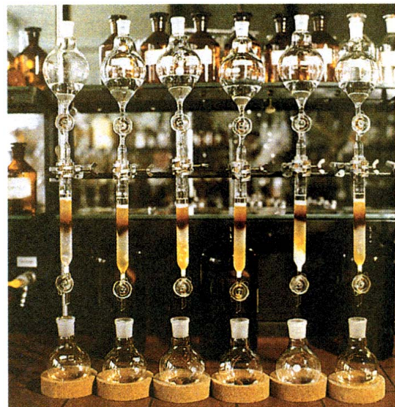
10.3 Chromatographie im Labor (Pflanzenschutzmittel)
