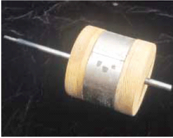
La armadura de madera sostiene ocho imanes neodimium-iron-boron arreglados con la polaridad alternadora alrededor esto es el perímetro
