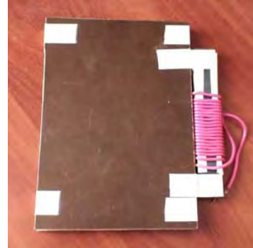
TRANSFORMADOR DE PROTOTIPO:
