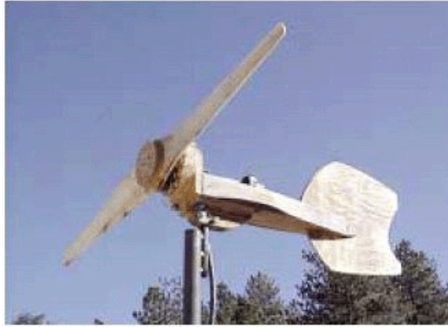
La siguiente generación es para la instalación permanente y produce más de 300 vatios en vientos de 30 millas por hora
