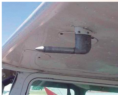
Las aeronaves utilizan tubos de pitot para medir la velocidad del aire.
