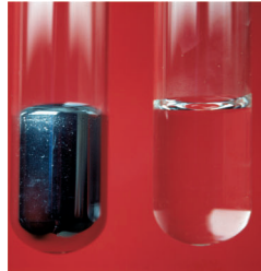
48.2 Quecksilber- und Wasseroberfläche im Reagenzglas
