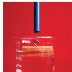
73.2 Schwimmender Körper: Auftrieb = Gewichtskraft
