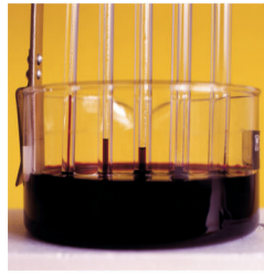
48.3 Enges Glasröhrchen - große Kapillarwirkung Weites Glasröhrchen - geringe Kapillarwirkung
