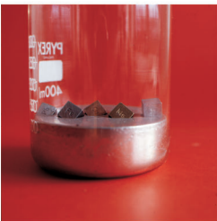
72.1 Metallwürfel schwimmen auf Quecksilber.
