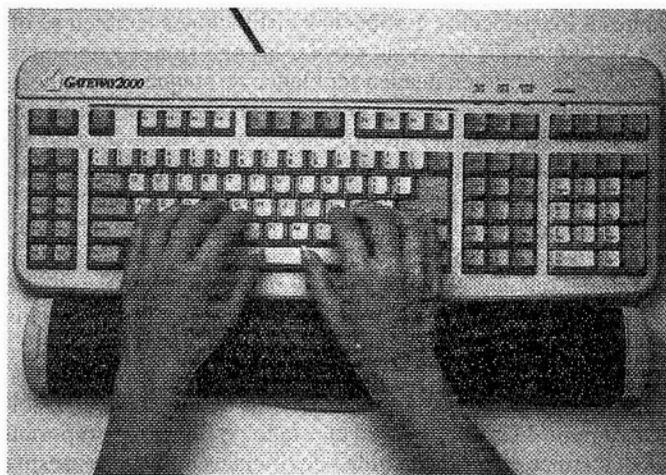
Figura 11-2. Dispositivo que se emplea para reducir la tensión en la muñeca de la persona al usar un teclado de computadora.
