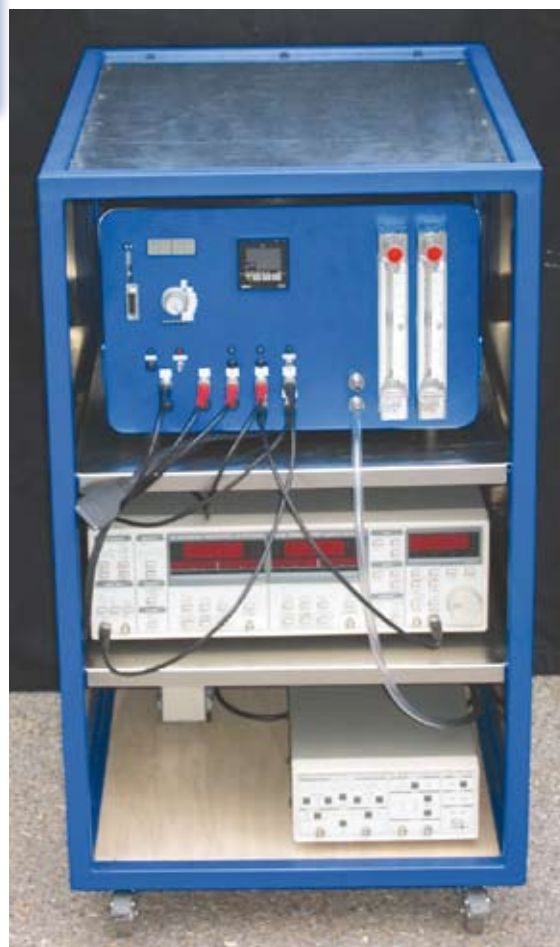
Abbildung 3: Optoakustisches System zur Rußmessung in motorischem Abgas.
