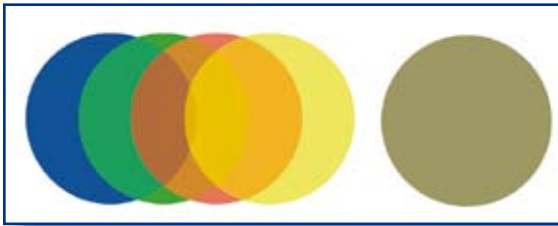
Abbildung 10: Modellsystem aus einem Paket von vier 1 mm dicken Folien.
